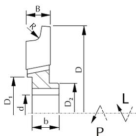
Фреза **F56-A 6.1** – это специальная насадная профильная фреза с количеством зубьев  $z=6.1$  предназначена для профессиональной обработки дерева и других древесных материалов, таких как ДСП, MDF и других. Фреза служит для закругления края доски радиусом согласно заказу. Ось резцов расположена под углом оси инструмента. Это позволяет достичь высокого качества обрабатываемой поверхности.
