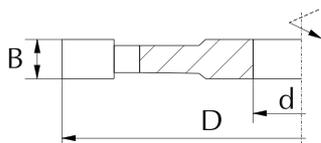
Фреза **3110 12.2** – это насадная прямая фреза с количеством зубьев  $z=12.2$  предназначена для профессиональной обработки дерева и других древесных материалов, таких как ДСП, MDF и других. Целостная конструкция гарантирует точное позиционирование фрезы на вале станка. Ось резцов – попеременно под углом оси инструмента. Это позволяет достичь высокого качества обрабатываемой поверхности. Большое количество зубьев дает возможность работать на высших подачах.
