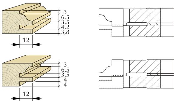
Набор фрез **FP-12** – это насадные профильные фрезы с количеством зубьев  $z=4.0$  предназначены для профессиональной обработки дерева и других древесных материалов, таких как ДСП, MDF и других. Служат для профилирования односторонних мебельных дверей. С помощью прокладок осуществляется регуляция обрабатываемого материала. Одним набором можно создать несколько профилей.
