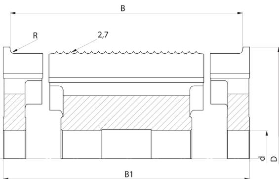
Набор фрез **FPO-03** – это насадные профильные фрезы с количеством зубьев  $z=4.0$  предназначены для профессиональной обработки древесины. Служат для профилирования террасной доски. С помощью прокладок осуществляется регуляция ширины обрабатываемого материала.
