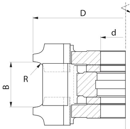
Набор фрез **FP-15** – это насадные профильные фрезы с количеством зубьев  $z=4.0$  предназначены для профессиональной обработки дерева и других древесных материалов, таких как ДСП, MDF и других. Служат для закругления углов в материале. С помощью прокладок осуществляется регуляция ширины обрабатываемого материала.
