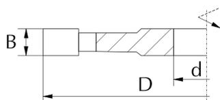
Фреза **3110 6.2** – это насадная прямая фреза с количеством зубьев  $z=6.2$  предназначена для профессиональной обработки дерева и других древесных материалов, таких как ДСП, MDF и других. Целостная конструкция гарантирует точное позиционирование фрезы на вале станка. Ось резцов – попеременно под углом оси инструмента. Это позволяет достичь высокого качества обрабатываемой поверхности.
