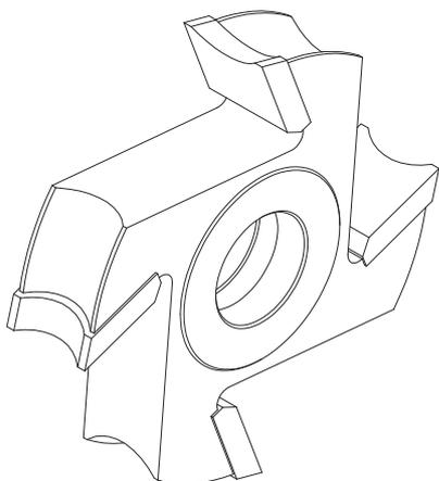
Фреза **P-116 4.0** – это насадная профильная фреза с количеством зубьев  $z=4.0$  предназначена для профессиональной обработки дерева и других древесных материалов, таких как ДСП, MDF и других. Фреза служит для закругления края доски радиусом согласно заказу.
