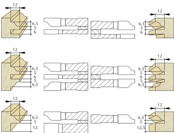
Набор фрез **FP-03** – это насадные профильные фрезы с количеством зубьев  $z=4.0$  предназначены для профессиональной обработки дерева и других древесных материалов, таких как ДСП, MDF и других. Служат для профилирования мебельных дверей. С помощью прокладок осуществляется регуляция обрабатываемого материала в диапазоне 22-35 мм. Одним набором можно создать несколько профилей.
