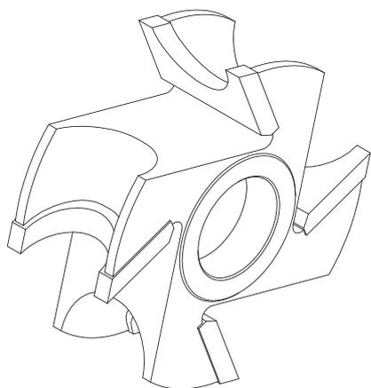
Фреза **P-107 4.0** – это насадная профильная фреза с количеством зубьев  $z=4.0$  предназначена для профессиональной обработки дерева и других древесных материалов, таких как ДСП, MDF и других. Фреза служит для фрезерования полувала радиусом согласно заказу.
